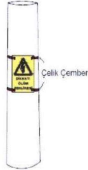
Yuvarlak ve Köşegen direkler için montaj resmi
